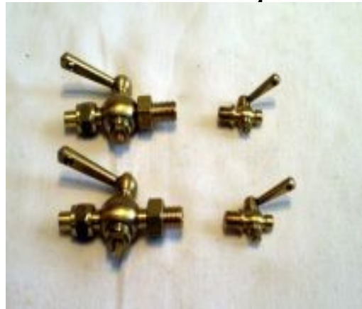
Die Zylinderentwässerungshähne, jede Baugröße im Vergleich.
