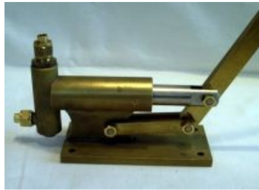
Auch ein wichtiges Bauteil der Dampfkessel ist die Handpumpe.
