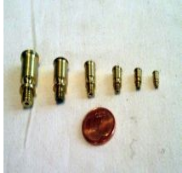
Eine kleine Auswahl von „Schmiermöglichkeiten“, für Dampfmaschinen - usw.
